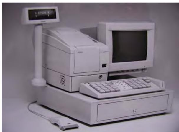
**バーコード読み取り用のハンデイスキャナも実用化が進んだ。エプソンPOSに接続されたバーコードハンデイスキャナ**
