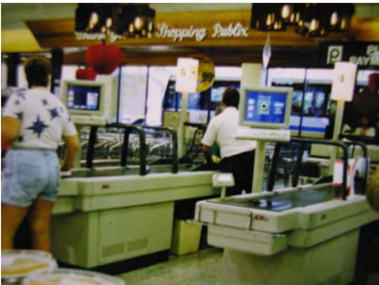
**1990年代にセルフスキャンシステム（チェックロボット）を導入したアメリカ・フロリダのパブリックス、30数個のセンサーでセキュリティを確保したが、余りにも大きなスペースを取ることにより新しいシステムに変わっていった**
