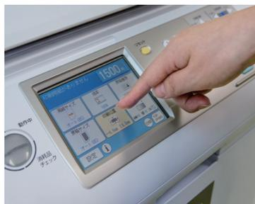
印刷する枚数などの設定は、すべてこのタッチパネル上で行う。フルカラー液晶だから、見やすく操作しやすい。原稿をセットしてスタートボタンを押すだけで、自動的に印刷がスタート!
