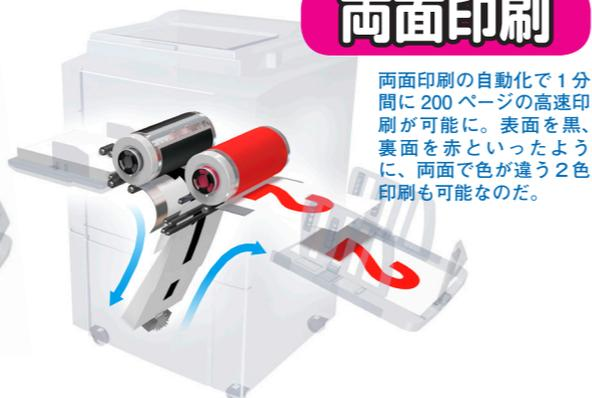
両面印刷の自動化で1分間に200ページの高速印刷が可能に。表面を黒、裏面を赤といったように、両面で色が違う2色印刷も可能なのだ。
